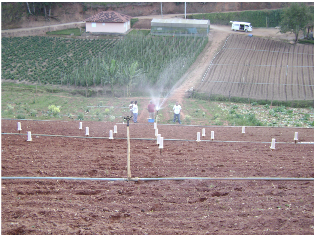
Figura 5.2 – Experimento para mensuração dos volumes de água da irrigação por aspersão, distribuição ao redor do aspersor.
