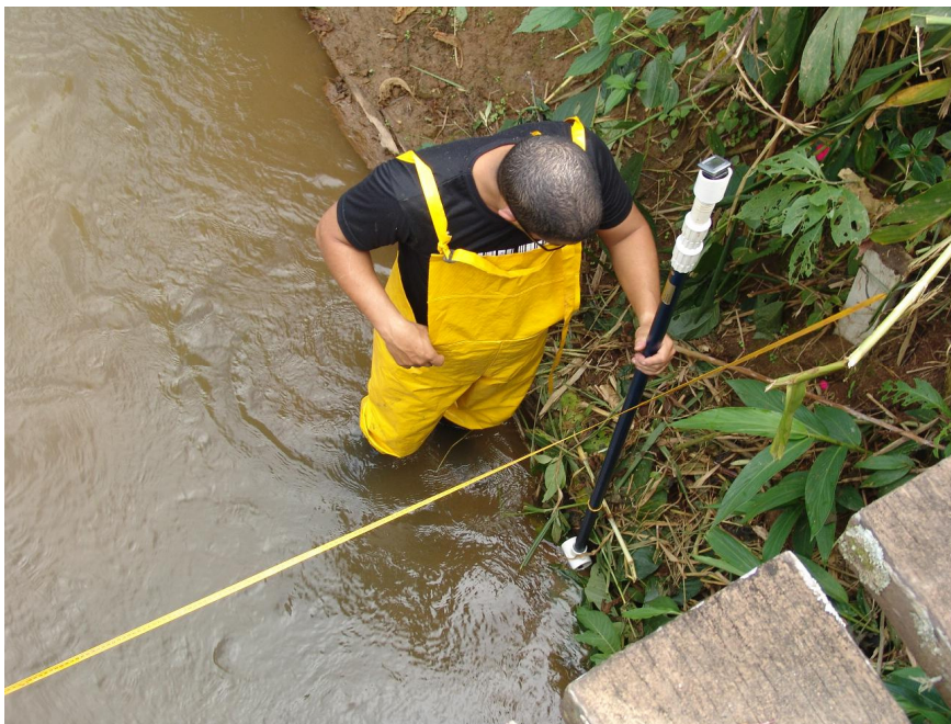
Figura 5.14 – Medição de Vazão com molinete hidrométrico na estação Baixo Curso.
