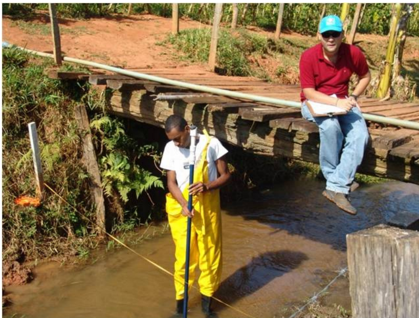
Figura 5.13 – Medição de vazão com molinete hidrométrico na estação Alto Curso.
