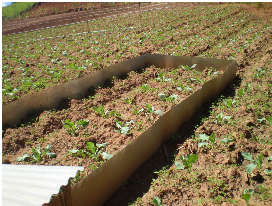
Figura 5.8 – Parcela hidro-erosiva na área de agricultura instalada na bacia do Córrego Sujo.
