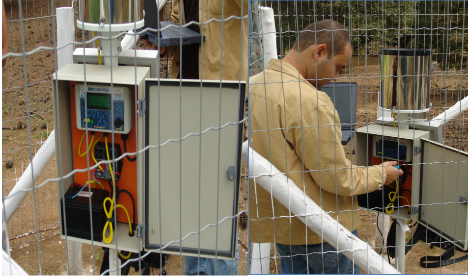
Figura 5.5 – detalhe da estação automática pluvio-fluviométrica Linígrafo Flex e b) retirada de dados mensal.
